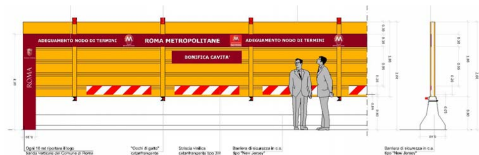
Fig. 5 Recinzione tipo pesante con pannelli fonoassorbenti per cantieri fissi
